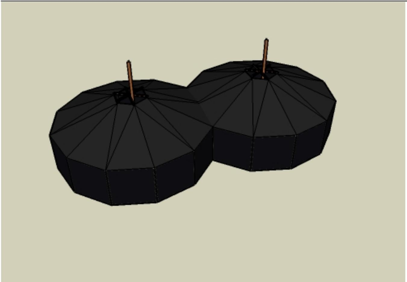
Elegant wird es bei der Verbindung von zwei Jurten über zwei Felder. Sie rücken dadurch etwas näher zusammen, der Durchgang wird so breit, dass du die Jurte fast schon als ein Raum nutzen kannst. Nur bleibt jetzt etwas Stoff übrig, der irgendwie verstaut sein will. Wenn du die beiden (eigentlich nun überflüssigen) Ecken mit einer langen Stange nach oben ziehst, dann verhindert die dadurch entstehende Haifischflosse auch jeglichen Wassersack oder undichte Knopfleisten.
