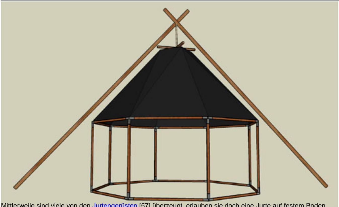
Mittlerweile sind viele von den [Jurtengerüsten](#) [57] überzeugt, erlauben sie doch eine Jurte auf festem Boden aufzustellen. Gerade, wenn keine Heringe verwendet werden können ist dies eine Möglichkeit die Zelte aufzustellen.
