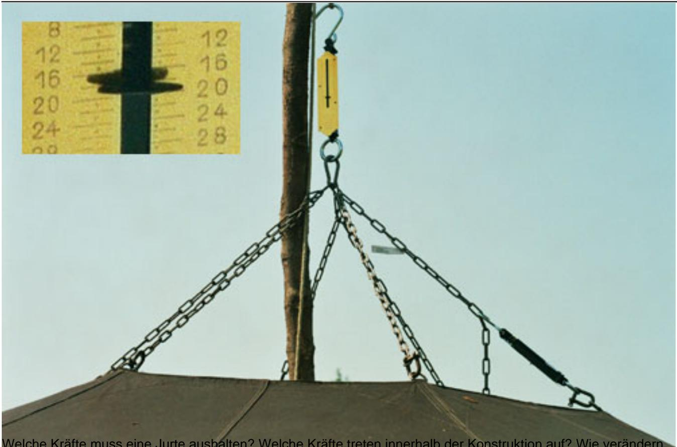
Welche Kräfte muss eine Jurte aushalten? Welche Kräfte treten innerhalb der Konstruktion auf? Wie verändern sich diese Kräfte zum einen bei Wind und Wetter, zum anderen bei verschiedenen Varianten des Aufbaus? Da uns diese Fragen schon lange im Geiste umtreiben haben wir mittel einiger Federwaagen die Größenordnungen dieser Kräfte experimentell gemessen.
