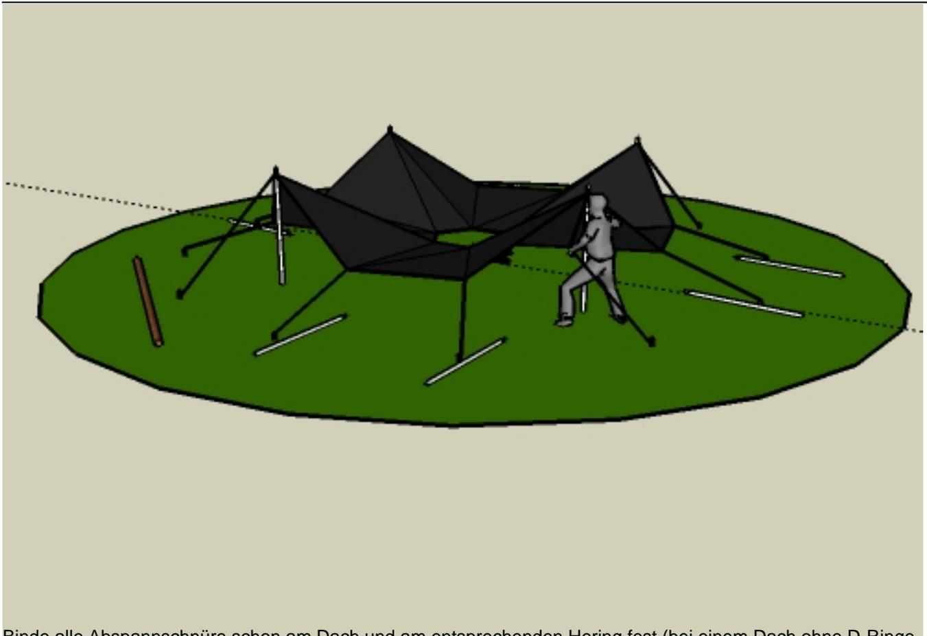
Binde alle Abspannschnüre schon am Dach und am entsprechenden Hering fest (bei einem Dach ohne D-Ringe jedoch nur am Hering). Lass das Seil jedoch recht locker. Nun kannst du die erste Stange aufstellen, dann die zweite gegenüber. Mit der dritten und der vierten Stange sieht deine Jurte dann bereits so ungefähr wie im Bild oben aus. Im Grunde geht das alles fast alleine, aber du tust dir gutes, wenn zumindest ein, zwei helfende Menschen dabei sind, welche dir in dem Stadium die Stange(n) halten.
