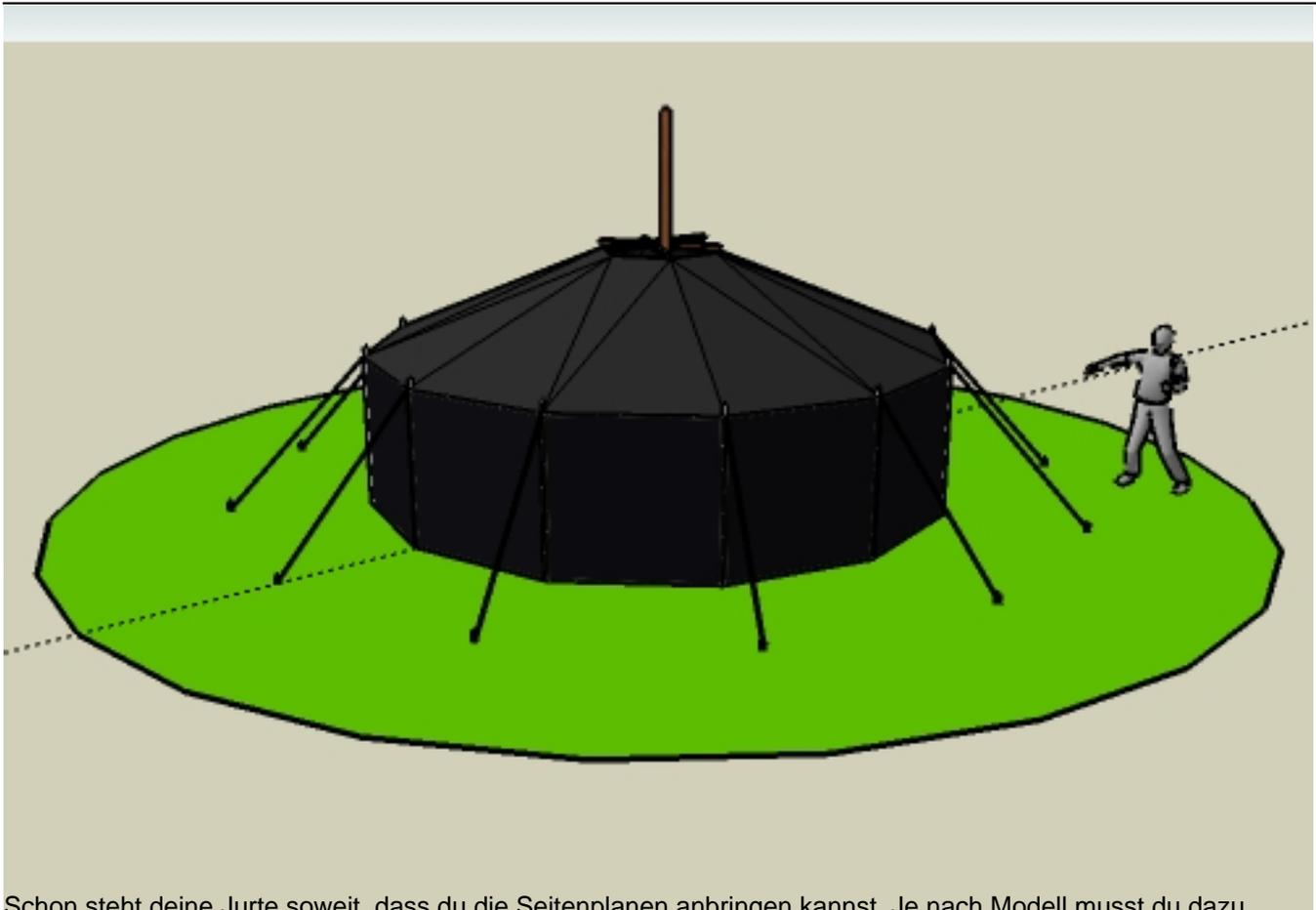
Schon steht deine Jurte soweit, dass du die Seitenplanen anbringen kannst. Je nach Modell musst du dazu nochmal eine nach der anderen Stange herausnehmen und die Ösen der Seitenplanen einhängen, aber dies geht ohne die Schnüre zu lockern, wenn du die Stange schräg nach innen anhebst.
