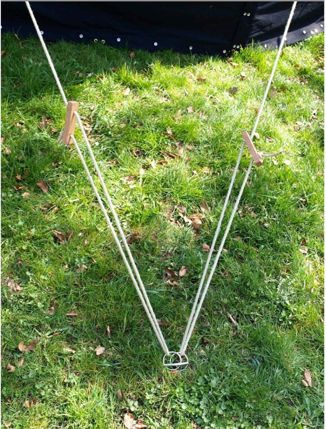
Die [Ringe](#) [4] an den Sicherheitsheringen schonen das Seil und verhindern das Einklemmen zwischen T-Profil und aufgeschweißtem Bügel. Auch kann der Hering wirklich komplett eingeschlagen werden und muss nicht mehr gelöst werden, um an den Abspannungen zu arbeiten.
