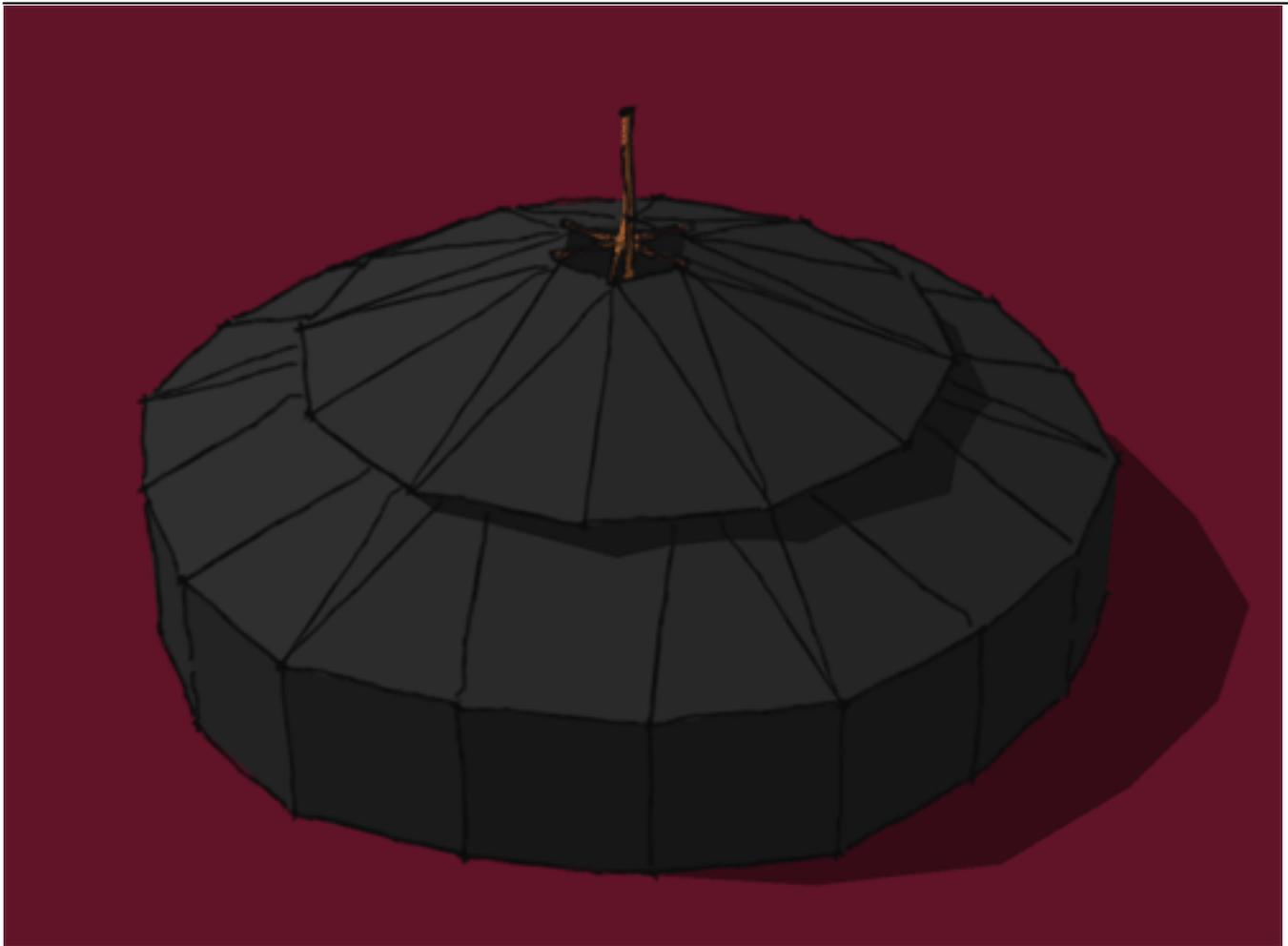
Um die Einzelteile der Konstruktion dicht zu bekommen, schichtest du einfach die verschiedenen Ebenen übereinander, ähnlich einer chinesischen Pagode. Ein gutes Bild dieser Konstruktion findest du auch im [Schwarzzeltarchiv des VCP Recke](#) [1].
