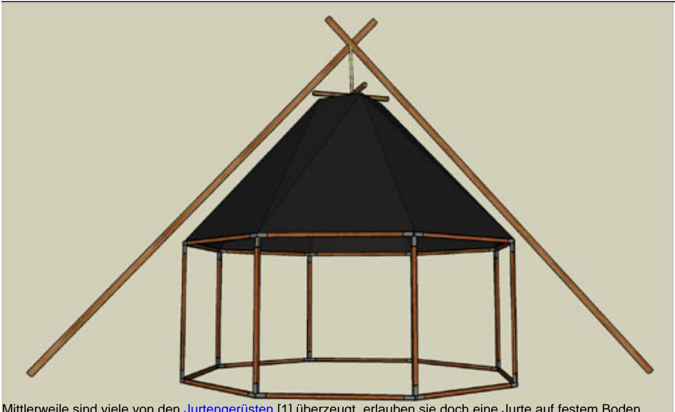
Mittlerweile sind viele von den [Jurtengerüsten](#) [1] überzeugt, erlauben sie doch eine Jurte auf festem Boden aufzustellen. Gerade, wenn keine Heringe verwendet werden können ist dies eine Möglichkeit die Zelte aufzustellen.
